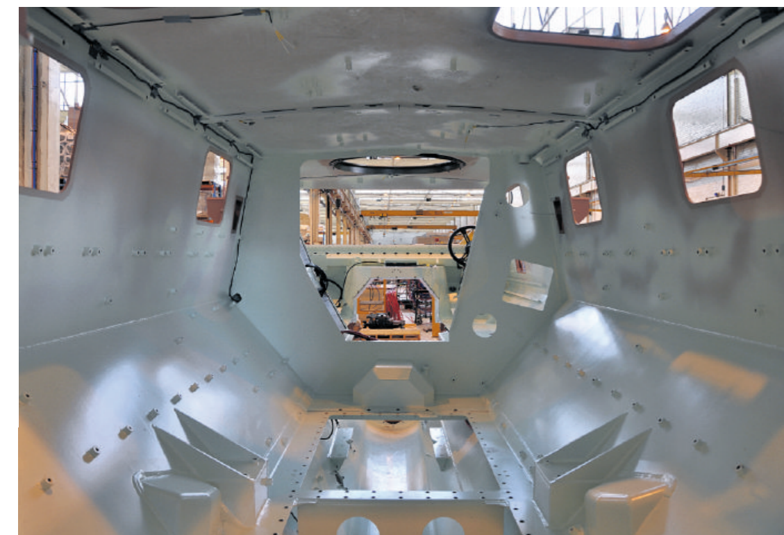
De binnenkant van een Bushmaster in aanbouw, met V-vormige bodem.
