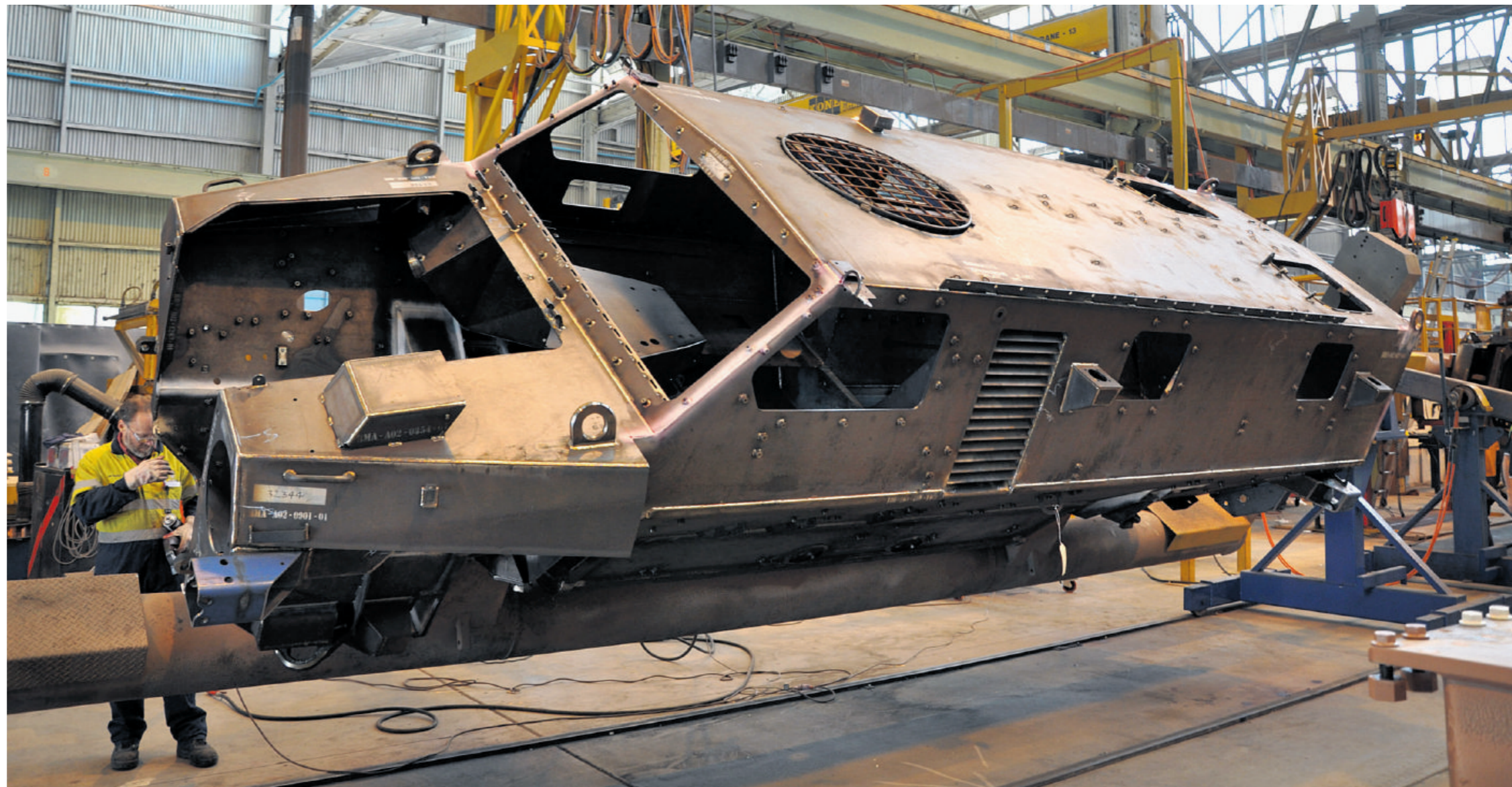
In een fabriekshal van defensieconcern Thales in het Australische Bendigo, ten noorden van Melbourne, worden Bushmaster pantservoertuigen met de hand gemaakt. Foto's Jeroen van Bergeijk
